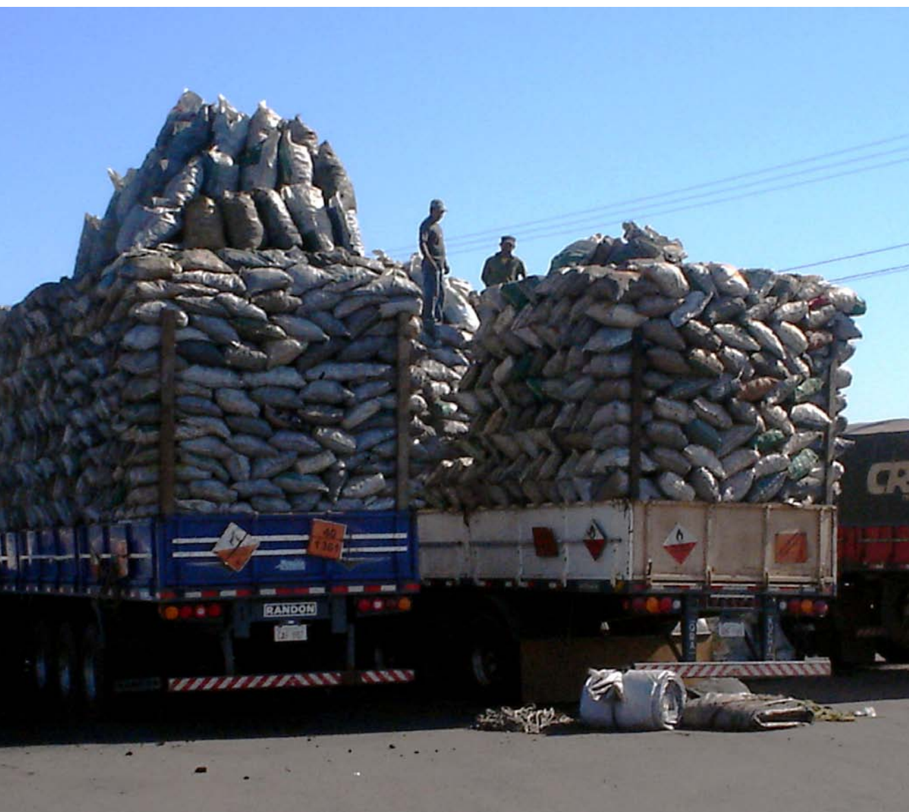
Fotografia: Caminhões do Paraguai parados na ponte Ayrton Senna, fronteira em Guaíra/PR, impedidos de trafegar, pela Polícia Rodoviária Federal, pelo excesso de altura na carga (4.40m é o máximo) e pela largura em relação ao eixo. Em 06/07/2010.
